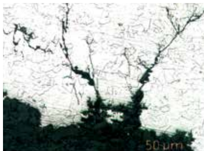
Një shembull i korrozionit tek pikat e tensionit në 1.4401 në ambient me sasi të lartë klori
